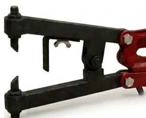
Места установки пуансонов в губках пробойника IMPERA ПП-10
