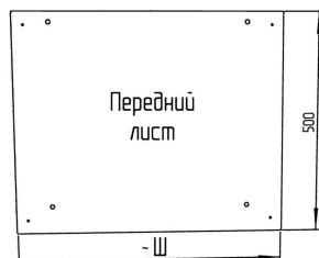
Рисунок 2. Передний и задний лист. Маркировка передней – ОНШ-Х-Х-03. Маркировка задней – ОНШ-Х-Х-04.
