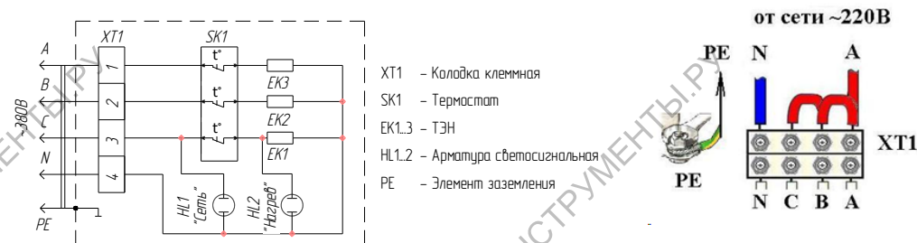
Рис.3 Схема электрическая принципиальная
