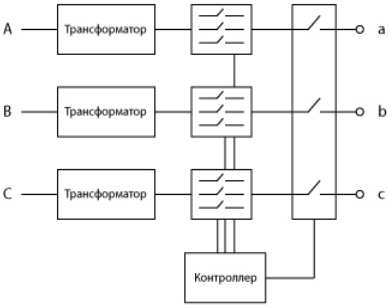
Рис. 3. Блок-схема стабилизатора напряжения
