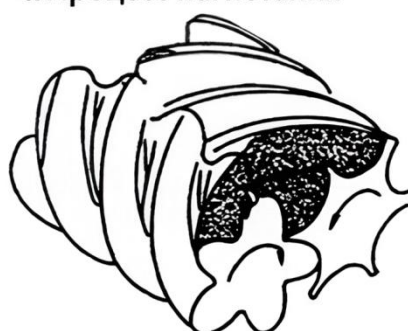
Рисунок 1 - Принципы сжатия в винтовом компрессоре
