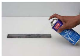
1. Очистите поверхность перед проведением работ
