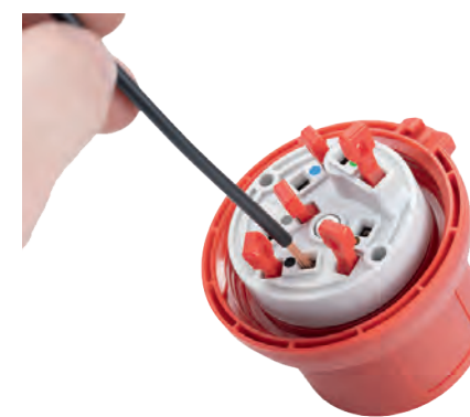
Вставьте защитный провод в открытые клеммы
