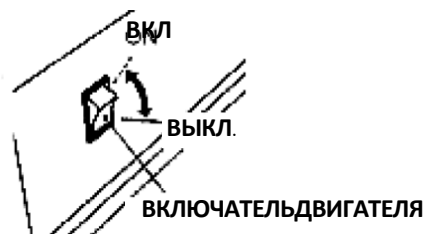
Без электрического пускателя
