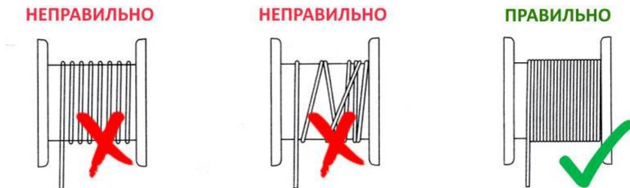
Рисунок 3. Намотка троса на катушку.
