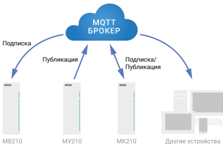
Figure 6.2 – Структурная схема обмена по протоколу MQTT
