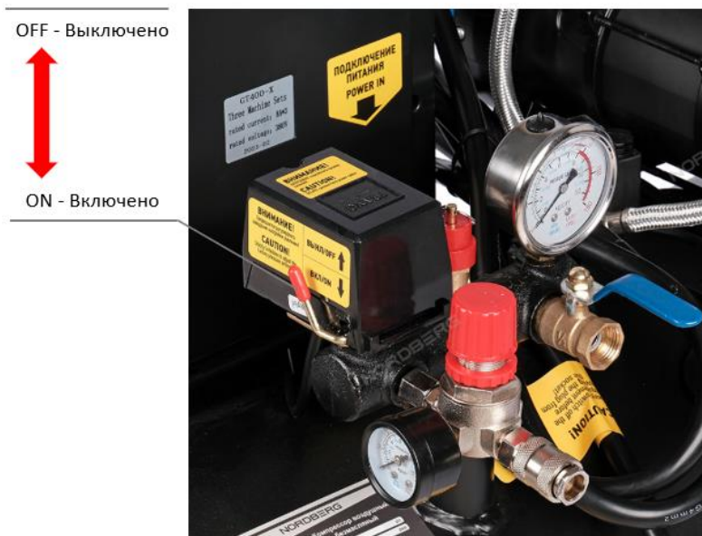
Рисунок 5 – Рабочие положения выключателя реле давления для NCEO50/500, NCEO135/500.
