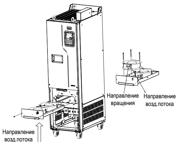
Рис. 9-2 Обслуживание вентиляторов в контейнерах T10~T12
