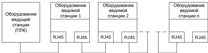
Рис. А-9 Электрические соединения линейной топологии сети
