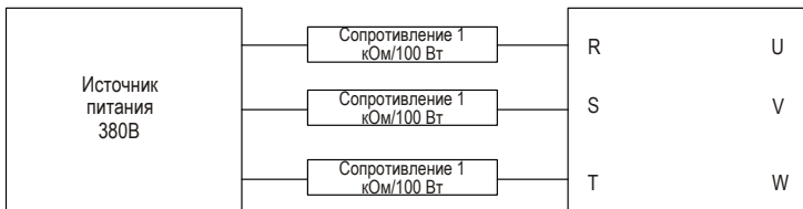
Рис. 9-3 Пример контура зарядки приводного механизма 380 В
