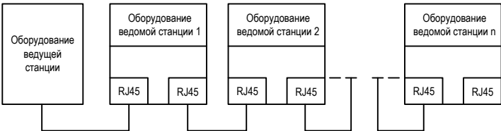
Рис. А-7 Электросхема линейной топологии сети
