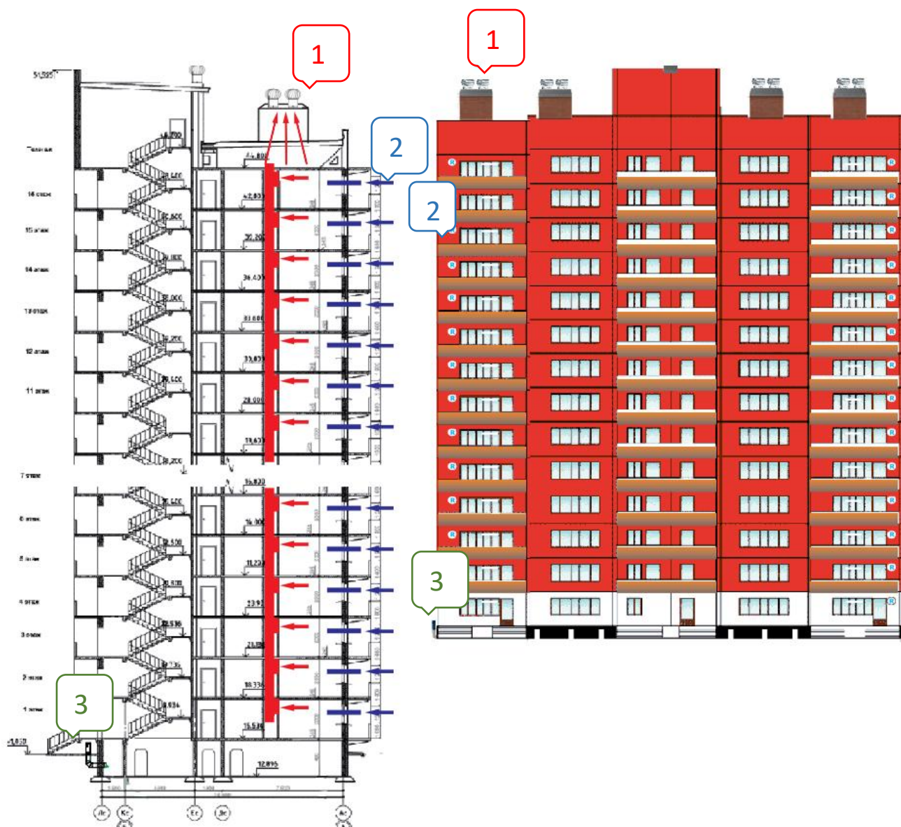
Рис. 4. Примеры установки устройств ROTADO на МКЖД
