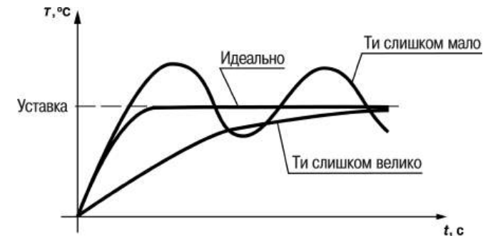
Рисунок 10.25 – Влияние T_i на выход на уставку
