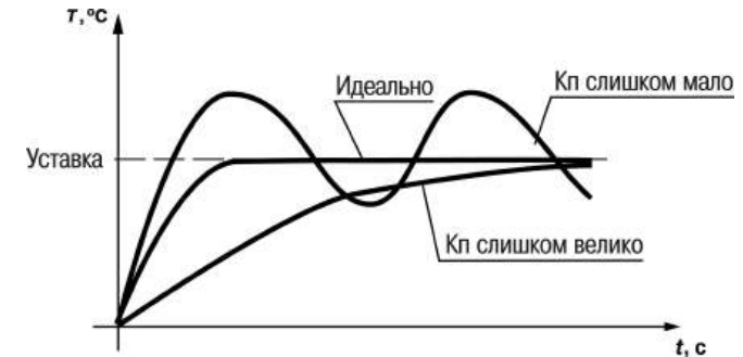
Рисунок 10.24 – Влияние K_p на выход на уставку
