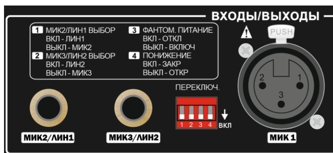
Рис. 7. DIP переключатель микрофон/линейный вход
