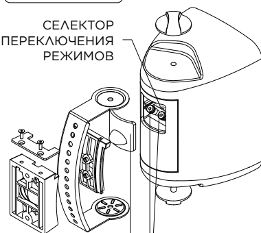
ГЕРМЕТИЧНАЯ КРЫШКА КЛЕММЫ ПОДКЛЮЧЕНИЯ АКУСТИЧЕСКОГО КАБЕЛЯ
