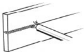
Рисунок 13. Горизонтальное положение при сварке
