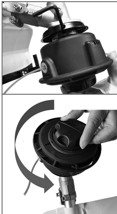
Рис. 5 Установка триммерной головки
