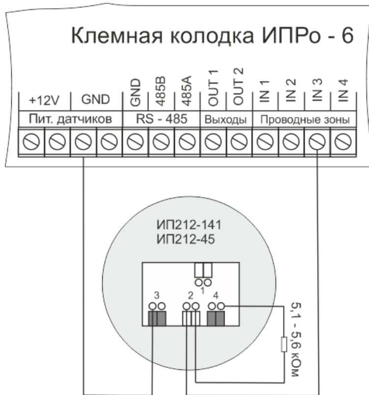
Подключение 1 датчика
