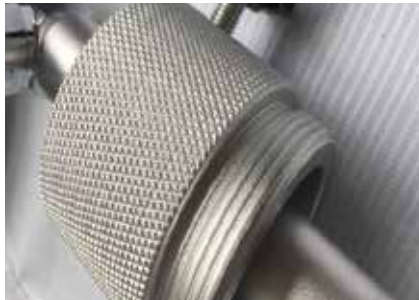
Изобр.4. Специальная нескользящая фиксирующая гайка
