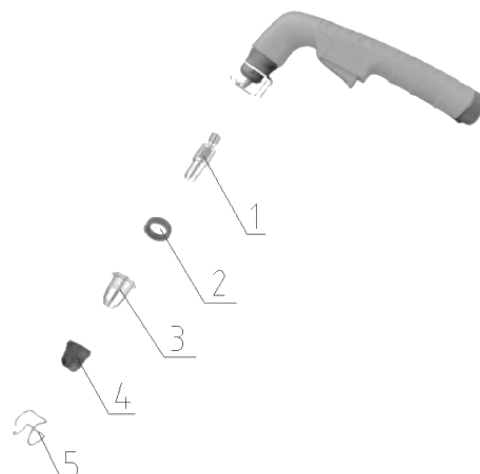
Рис. 5 Схема плазменной горелки/резака
