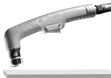
Рис. 6 Корректировка расстояния между рукавом и заготовкой
