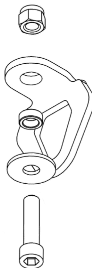
рис. 3 Крепление анкерной точки на металлическое основание
