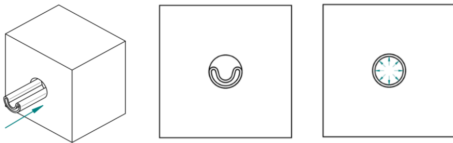
Рис. 5. Установка теплоизоляции в канал трубы.
