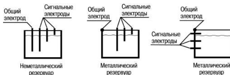
Рисунок 6.4 – Примеры установки кондуктометрических зондов
