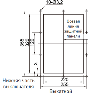
Рисунок 8 - Минимальные расстояния от токоведущих частей и металлических частей РУ до выключателя Протон М стационарного и выдвижного исполнения
