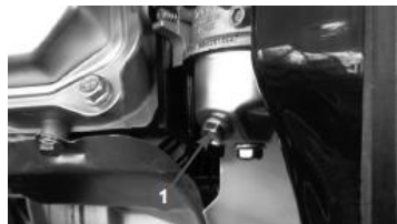
СЛИВ ТОПЛИВА ИЗ КАРБЮРАТОРА 1. Болт сливной
