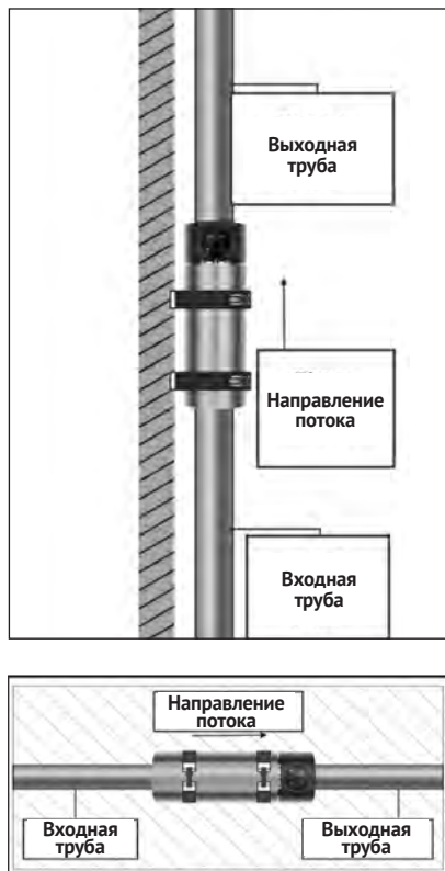
Рисунок 3 – Вертикальная или горизонтальная установка
