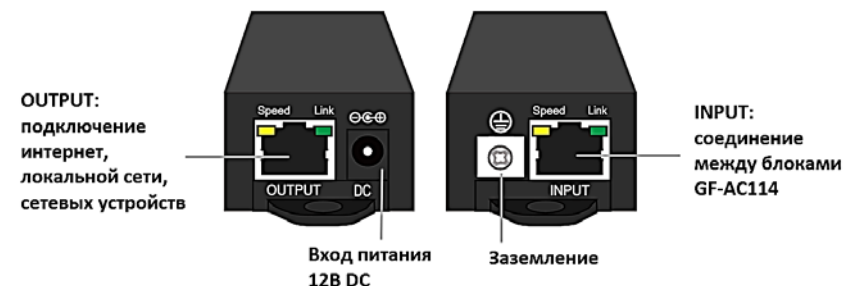
Рис. 2. Расположение и назначение элементов коммутации.
