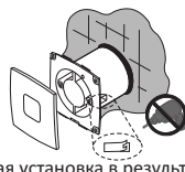
Быстрая установка в результате натяжения зажимов в любое отверстие (для моделей A100XS / A120XS)
