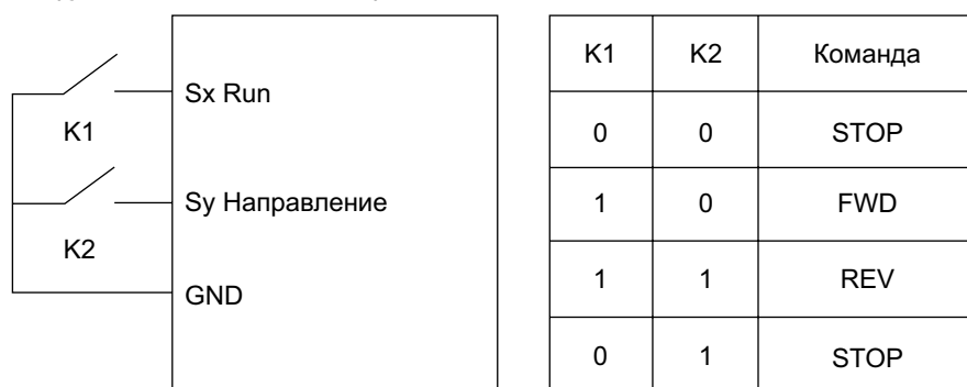
Рисунок 3. Двухпроводное управление тип 2
