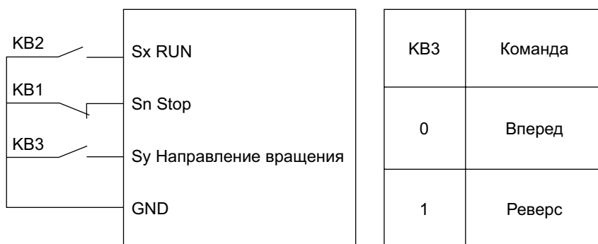
Рисунок 5. Трехпроводное управление тип 2
