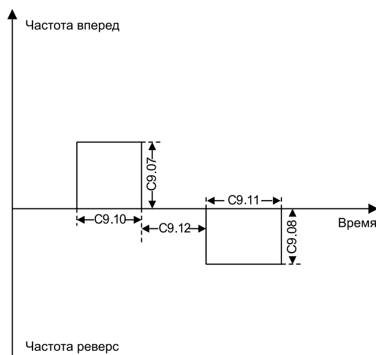
Рисунок 25. Осциллограмма работы функции очистки насоса
