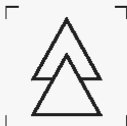
Рисунок 3 — Работа под напряжением (двойной треугольник)
