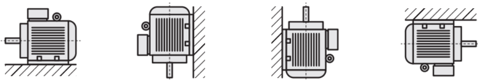
Рисунок 3 – Монтажное положение электродвигателя исполнения IM1081
