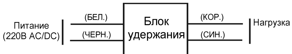
Рисунок 1. Схема подключения Блока Удержания.
