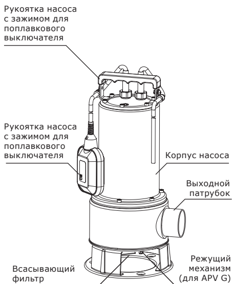
Рис. 4 Конструкция насосов APV.40B/45B/50B V/G
