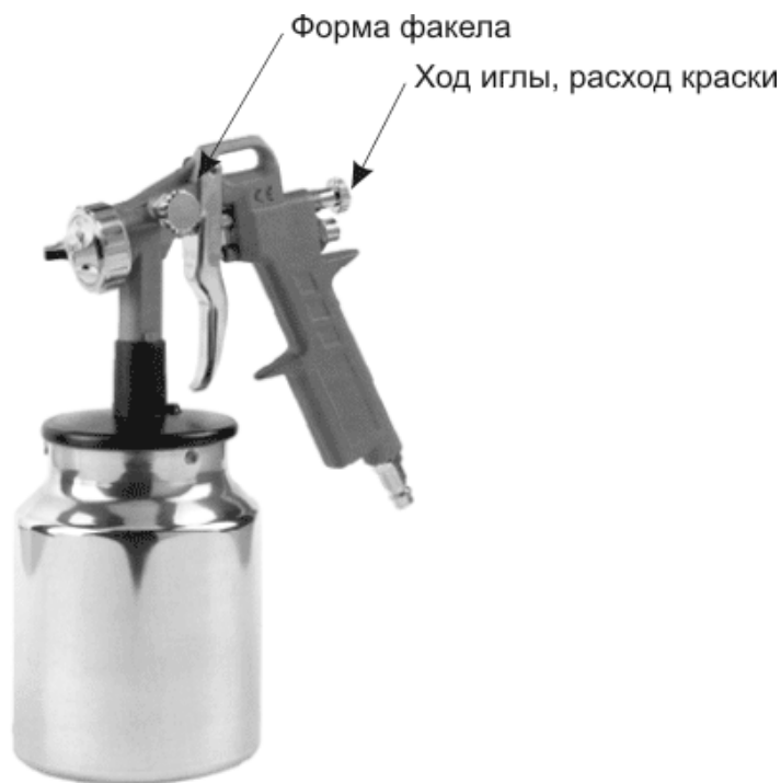
Рис. 4 Регулировки краскораспылителя
