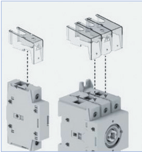
Установка защитных крышек
