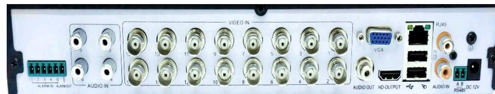
Рис. 1. Расположение разъемов на задней панели Прибора
