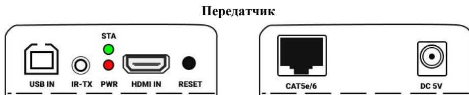
Рис. 1. Расположение и назначение элементов коммутации. Передатчик.
