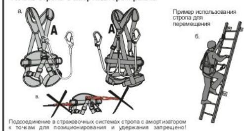
Рис. 4. В страховочных системах допускается использование только стропы с амортизатором рывка
