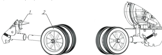
Рис. 4. Установка опорного колеса.
