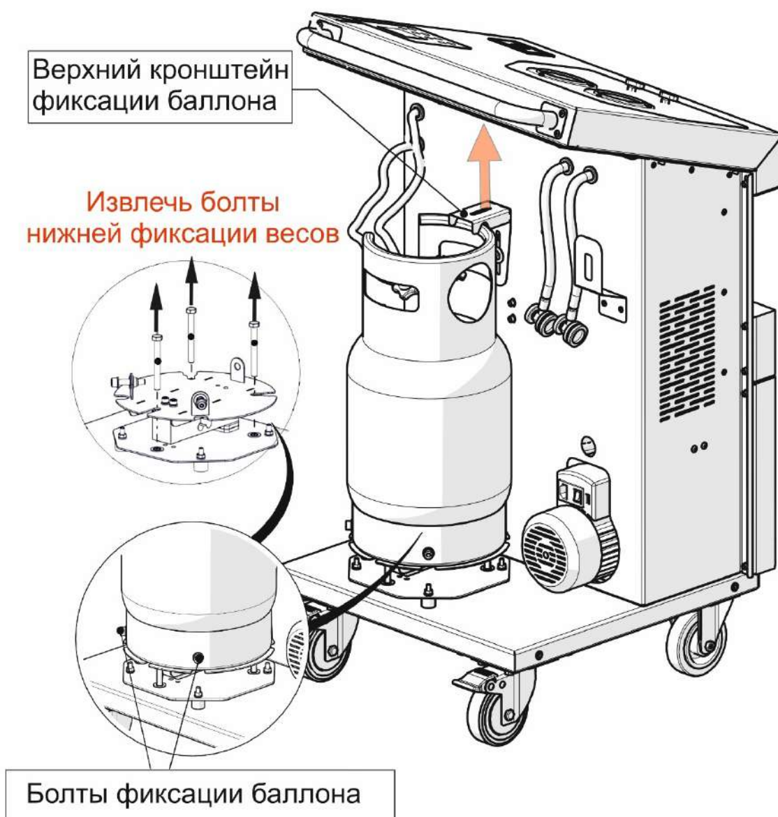
Рис. 5 Фиксация внутреннего бака
