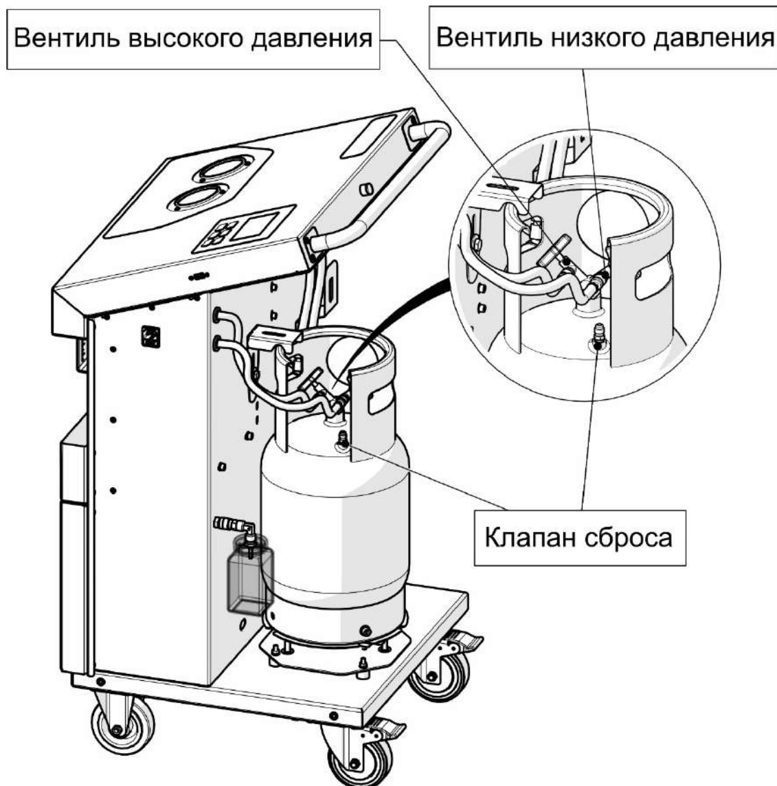
Рис. 7 Сброс неконденсируемых газов.
