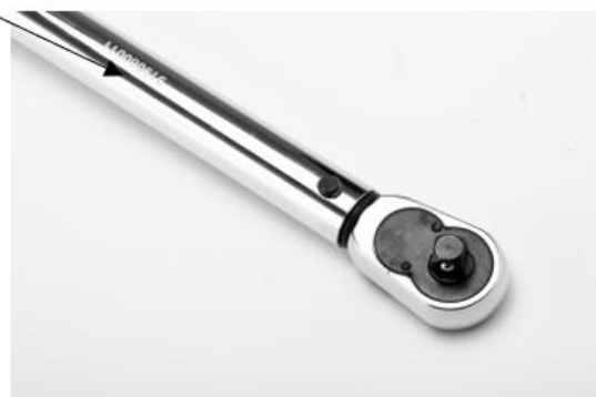
Рисунок 9 - Пример нанесения информации об модификации (исполнении) (а), серийном номере (б) ключа динамометрического (моментного) предельного SATA
