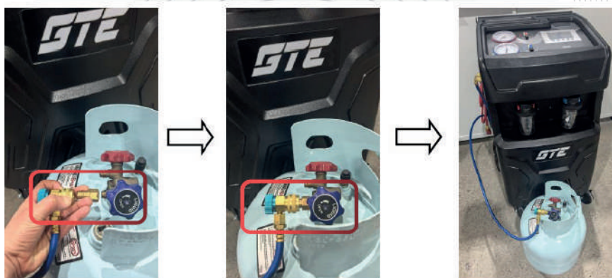
СИНИЙ КЛАПАН - ЖИДКОСТНАЯ МАГИСТРАЛЬ (LP) БАЛЛОНА-ИСТОЧНИКА
