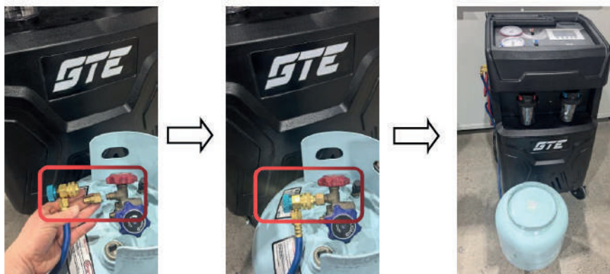
КРАСНЫЙ КЛАПАН – ГАЗОВАЯ МАГИСТРАЛЬ (НР) БАЛЛОНА-ИСТОЧНИКА
