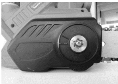
Установка и натяжка цепи
