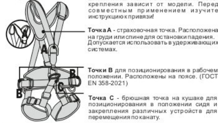
Рис. 4. Расположение и назначение крепежных точек на привязях
