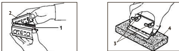
1 - держатель ножа; 2 - нож; 3 - гайки крепления; 4 - брусок
