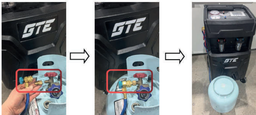
КРАСНЫЙ КЛАПАН – ГАЗОВАЯ МАГИСТРАЛЬ (НР) БАЛЛОНА-ИСТОЧНИКА
