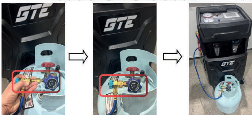
СИНИЙ КЛАПАН - ЖИДКОСТНАЯ МАГИСТРАЛЬ (LP) БАЛЛОНА-ИСТОЧНИКА
