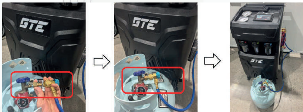
СИНИЙ КЛАПАН - ЖИДКОСТНАЯ МАГИСТРАЛЬ (LP) БАКА-ИСТОЧНИКА
