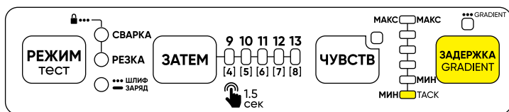
Рисунок 4. Функционирование режима прихваток «TACK»
