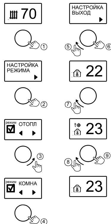
Рисунок 5. Выбор и настройка температуры режима «КОМНАТНЫЙ»
